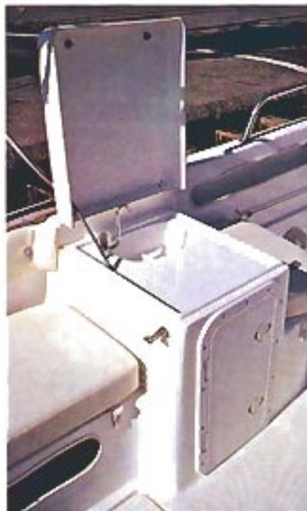
Un módulo en la banda de babor incluye el fregadero y un buen armario inferior en el que cabe una nevera. Se puede incorporar un pequeño fogón para que haga las funciones de cocina auxiliar.
